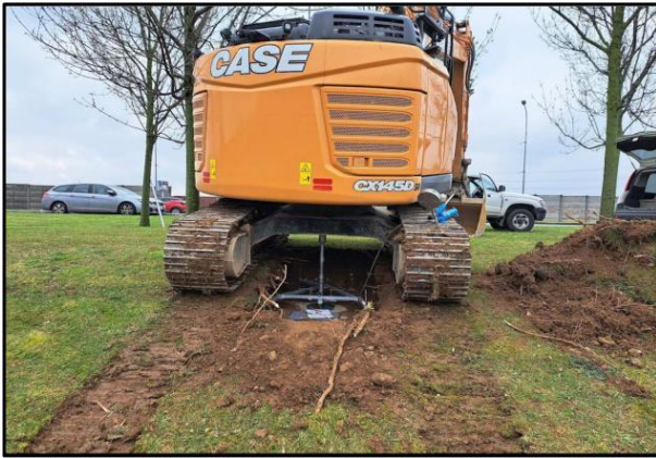
Fig. 6 – Prova di carico su piastra (PCP02).
