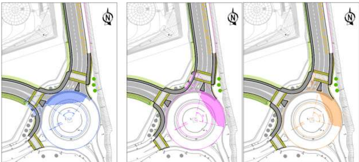
Figura 18: Verifica di visibilità intersezione
